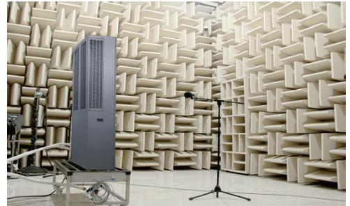
可检测产品：风冷冷风机组、风冷冷水机组 / 水冷冷水机组、水冷冷风机组 / 冷冻水机组、风机盘管、空气源热泵 / 热泵热水机等。
