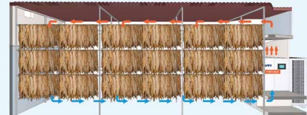
海悟烟草烘干热泵主机为双系统独立设计，可按需调节输出热量，实现对烘干房原有热源的轻松替换。烘干热泵通过热风循环的方式，使得烘房的温度升高，将物料中的水分汽化蒸发，按所设定的干球温度、湿球温度要求，由智能控制系统运行，实现将烟叶烘干的目的。
