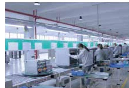
**电控车间** 生产面积 5000m<sup>2</sup> 电控车间年加工能力超1000000件；PCBA老化测试及E- BOX半成品接线组装
