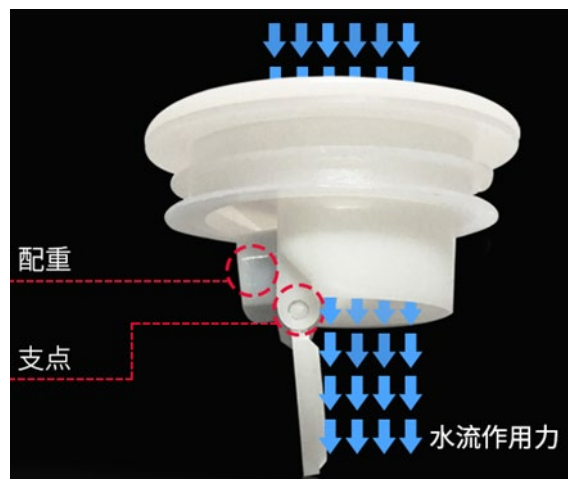
图 18 地漏防反水原理图
